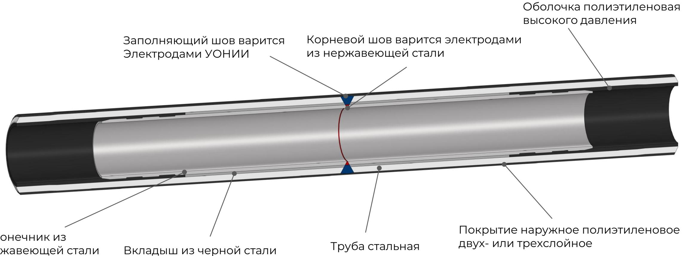
Наконечник МПТ-К, выполненный из коррозионностойкой стали и предназначен для защиты сварного стыка от коррозии
