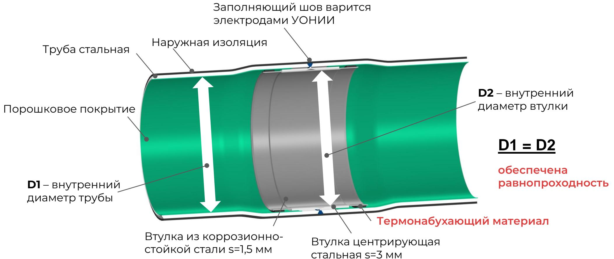
Втулка ТПС-К – нержавеющая втулка с терморасширяющимися уплотнительными элементами обеспечивает защиту сварного стыка от коррозии
