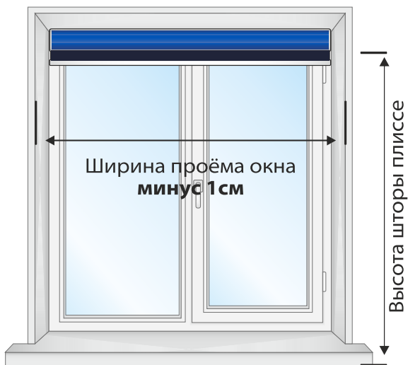
Монтаж карниза в проём окна
