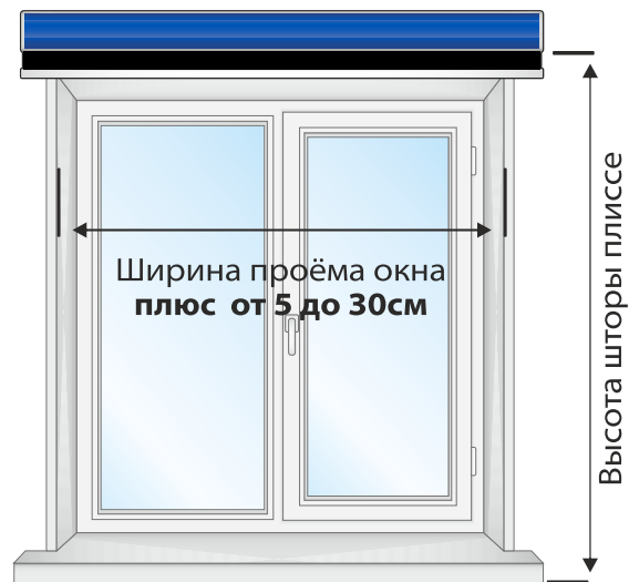
Монтаж карниза над проёмом окна
