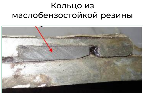
Центратор с теплоизоляционным материалом
